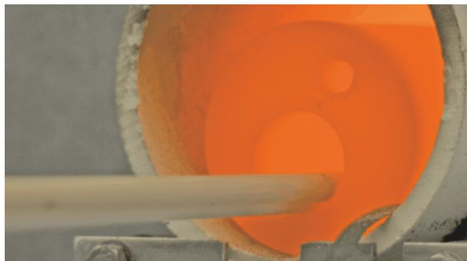
Рисунок 5: Измерение высоких температур до 1800 °C
