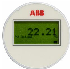
Рисунок 7: LCD-дисплей
