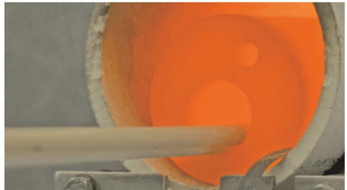
Abbildung 5: Hochtemperaturmessung bis 1800 °C
