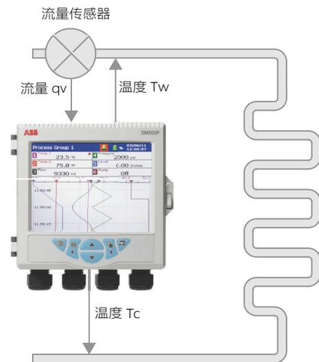
温度  $T_w$  是指系统供水侧的水温；它们是进入冷水机组、提供空气冷却功能的水。温度  $T_c$  是指系统回水侧的水温；它们是被用于冷却空气的、当前温度较高的水。最后， $q_v$  是指通过系统供水侧的水流量。
