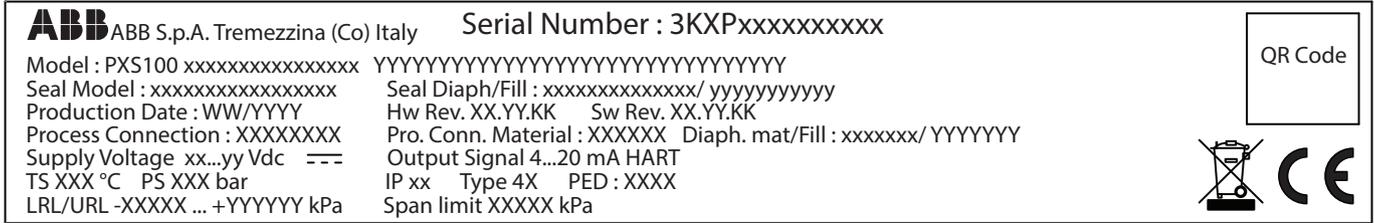
Abbildung 2 - Typenschild für den Druck-Messumformer Modell PGSxxx/PASxxx
