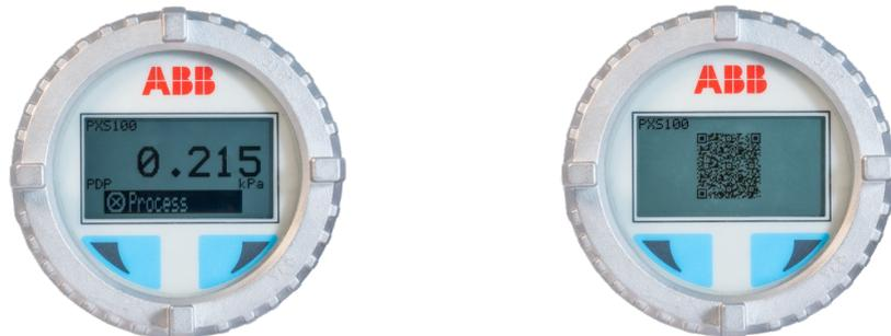
Durch das Scannen des QR-Codes hat der Betreiber Zugriff auf ein spezifisches Dokument im PDF-Format mit Angaben zur der empfohlenen Maßnahme für die Beseitigung des Fehlers/der Störung.
