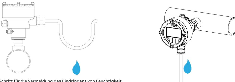
Abbildung 7 - Schritt für die Vermeidung des Eindringens von Feuchtigkeit
