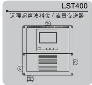
在距离模式下，LST400 测量被测物与传感器之间的距离。也就是说，20mA 是最远点，4mA 是最近点。在物位模式下，LST400 测量罐内物位。也就是说，在最远点或者空罐时，仪器读数为 4mA。在最近点，或料罐为满罐时，仪器读数为 20mA。
