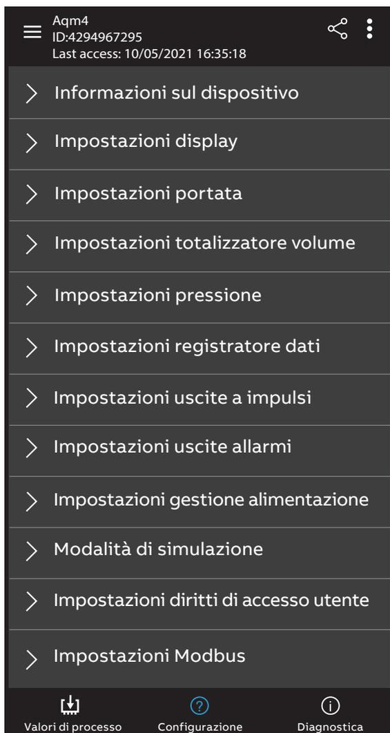
**Figura 75** Finestra Configurazione
