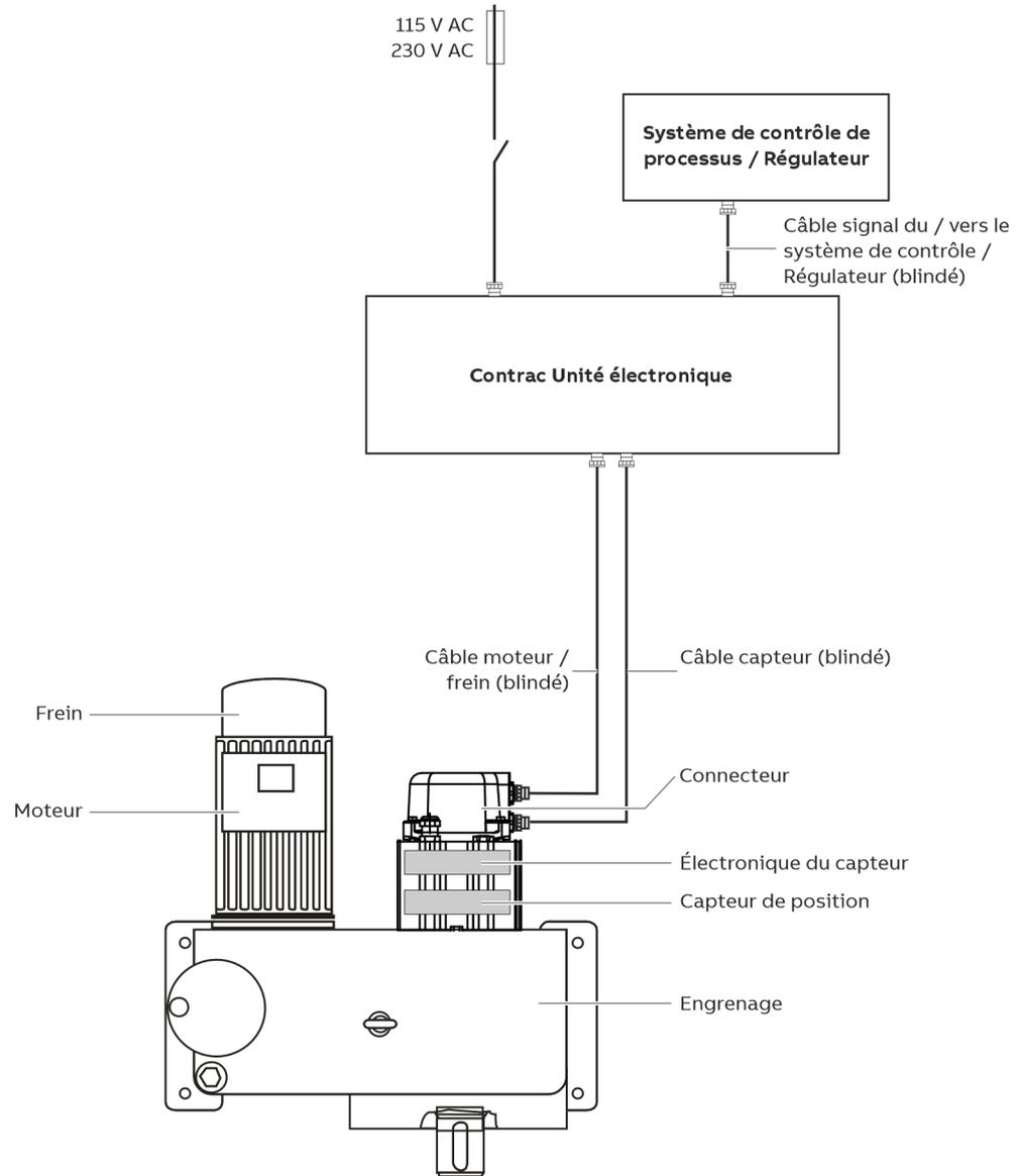
Figure 3 : Disposition des modules Contrac (exemple)
