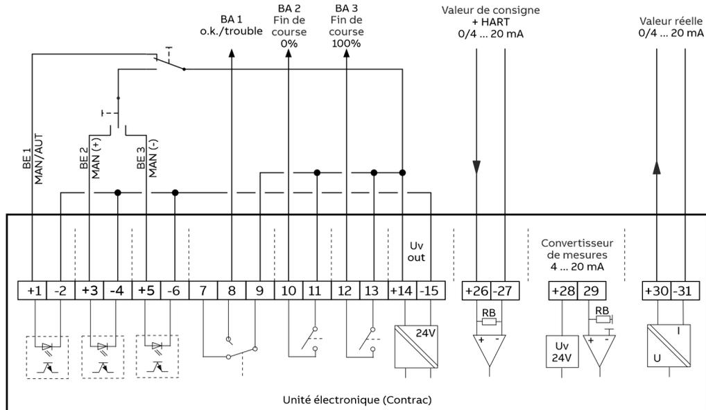
Figure 13 : Exemple de raccordement pour le fonctionnement selon la valeur de consigne continue (configuration standard)
