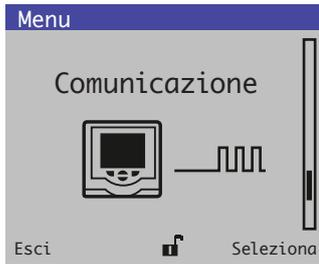
I menu del livello **Comunicazione** per Modbus, Profibus, HART, Ethernet sono abilitati solo è installato un modulo di comunicazione opzionale.
