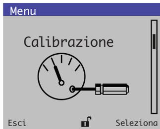
La calibrazione di conducibilità/concentrazione/temperatura è un'intelligente procedura di calibrazione a un punto che consente calibrazioni a punto singolo o a due punti. Avviando calibrazioni a due diversi valori di conducibilità/concentrazione/temperatura con un'ampia separazione, il trasmettitore AWT420 regola automaticamente offset, pendenza o entrambi per ottenere le migliori prestazioni del sensore.
