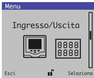
Consente di abilitare la configurazione delle uscite analogiche, uscite e ingressi digitali e relè.
