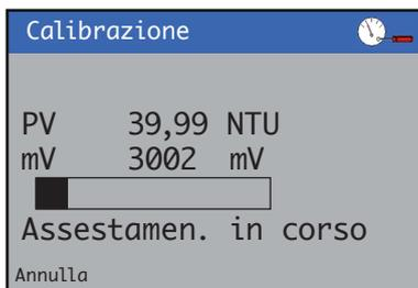
Vengono visualizzati i risultati della calibrazione. (Premere il tasto
