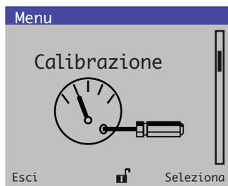
Questa sezione descrive il metodo di calibrazione del sensore, che comprende la misurazione della sensibilità del sensore a pH e temperatura esponendo il sensore a campioni con valori di pH/temperatura noti.
