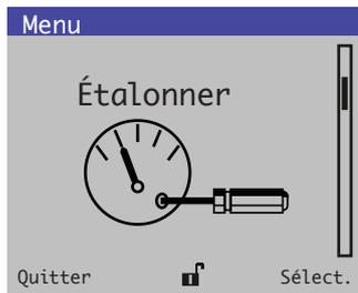
L'étalonnage de la conductivité / concentration / température est une routine intelligente d'étalonnage en un point qui permet des étalonnages en un ou deux points. En lançant les étalonnages à deux valeurs de conductivité / concentration / température différentes et suffisamment espacées, le transmetteur AWT420 ajuste automatiquement le décalage, la pente ou les deux pour obtenir les meilleures performances du capteur.
