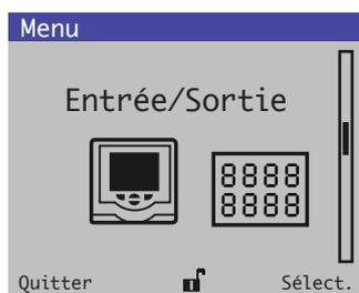
Permet d'activer la configuration des sorties analogiques, des entrées et sorties numériques, ainsi que des relais.
