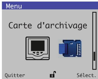
Permet d'activer / désactiver l'enregistrement de données, de sélectionner la source des données à enregistrer, de sauvegarder et de charger les fichiers de configuration et de formater des médias externes.
