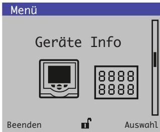
Anzeige der schreibgeschützten, werksseitig vorgegebenen Angaben für die Software des Messumformers und den angeschlossenen Sensor(en).
