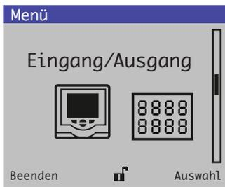
Ermöglicht die Konfiguration von Analogausgängen, digitalen Ein- und Ausgängen und Relais.
