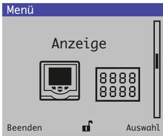
Dient zum Auswählen der Anzeigesprache, zum Einrichten von Beispielen für **Bedienerseiten** (1 bis 3), zum Aktivieren von Diagnose-, Ansicht- und Protokollfunktionen sowie zum Einstellen von Helligkeit/Kontrast der Geräteanzeige und von Zeit und Datum.
