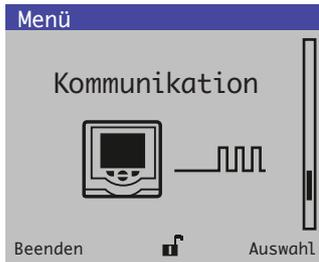
Die Ebenenmenüs für die **Kommunikation** Modbus, Profibus, HART, Ethernet sind nur aktiviert, wenn ein optionales Kommunikationsmodul eingebaut ist.
