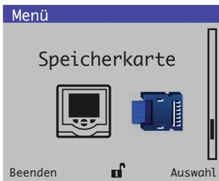
Dient zur Aktivierung/Deaktivierung der Datenprotokollierung, zum Auswählen der Quelle der zu protokollierenden Daten, zum Speichern und Laden von Konfigurationsdateien und zur Formatierung externer Speichermedien.
