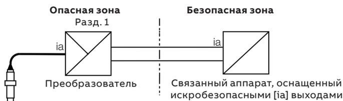
Рис. 9 Искробезопасное исполнение – Канада
