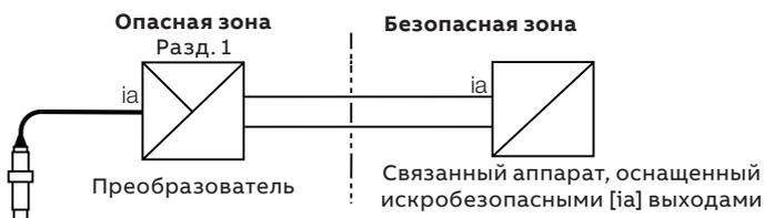
Рис. 7 Искробезопасное исполнение — FM
