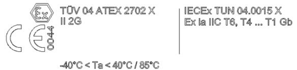
Abbildung 1: Ex-Kennzeichnung (Beispiel, ATEX / IECEx)
