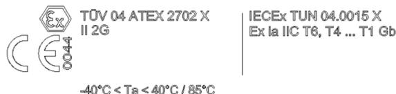
Abbildung 1: Ex-Kennzeichnung (Beispiel, ATEX / IECEx)
