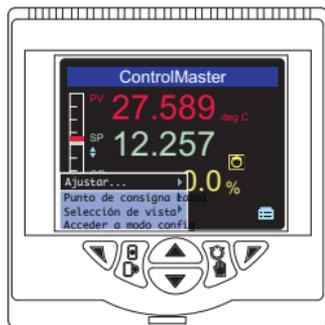
Los menús del nivel de operador sirven para ajustar puntos de consigna y salidas, seleccionar los puntos de consigna, seleccionar la vista y acceder a los modos *Básico* y *Avanzado* (mediante el Nivel de acceso).
