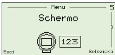
Utilizzato per impostare la *Modalità display* (righe delle informazioni visualizzate sulle *Pagine operatore*), abilitare o disabilitare *Scorrimento autom.*, impostare la data e l'ora e il formato di data e ora, selezionare una regione dell'*Ora legale* e regolare il contrasto dello schermo.
