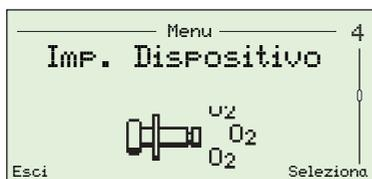
Utilizzata dagli utenti *Avanzati* per impostare l'etichetta strumento, specificare il tipo di sonda, selezionare la lunghezza del cavo, impostare le gamme di ossigeno e la temperatura e impostare le password per l'accesso a tutti i livelli.
