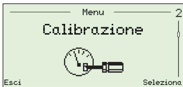
Utilizzata per tarare il sensore, selezionare il tipo di gas di prova, impostare il blocco attivo ossigeno, abilitare l'hardware di taratura automatica (se presente) e impostare le opzioni di diagnostica della taratura.
