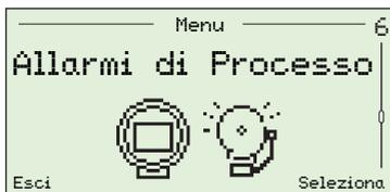
Utilizzato per impostare gli allarmi di processo (da 1 a 4) per i tipi di allarme (ossigeno alto/basso o temperatura alta/bassa), impostare le temperature di soglia allarme e impostare i valori di isteresi (valore espresso in % per l'ossigeno e °C per la temperatura).
