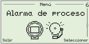
Se utiliza para configurar las alarmas de proceso (1 a 4) de los tipos de alarma (oxígeno alto/bajo o temperatura alta/baja), ajustar las temperaturas de disparo de la alarma y los valores de histéresis (en un valor de % para el oxígeno y de °C para la temperatura).
