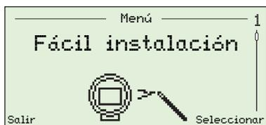
El menú *Fácil instalación* contiene una serie de opciones de configuración rápida para usuarios con acceso de nivel *Avanzado*.
