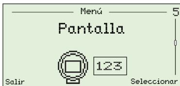
Se utiliza para ajustar el *Modo de visualización* (líneas de información mostradas en las *Páginas del operador*), activar o desactivar el *Autodesplazamiento*, ajustar la fecha y la hora y el formato de la fecha y la hora, seleccionar una región de *Cambio de horario de verano* y ajustar el contraste de la pantalla.
