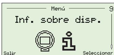
Identifica el número de serie del transmisor, la fecha de fabricación del transmisor, la última fecha de calibración del oxígeno, el tipo de sonda, la tarjeta opcional del transmisor (si está instalada), el hardware de calibración automática (si está instalado) y los números de tarjeta principal y versión de software.
