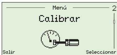
Se utiliza para calibrar el sensor, seleccionar tipos de gases de prueba, ajustar la acción de retención de oxígeno, activar el hardware de calibración automática (si está instalado) y ajustar las opciones de diagnóstico de calibración.
