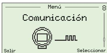
Se utiliza para configurar los parámetros de comunicaciones HART y la comunicación de salida cíclica mediante la interfaz IrDA del frontal del transmisor.
