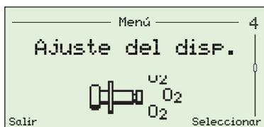
Utilizado por usuarios *Avanzados* para asignar el nombre del instrumento, especificar el tipo de sonda, seleccionar la longitud del cable, ajustar los rangos de temperatura y oxígeno y configurar las contraseñas de acceso para todos los niveles.
