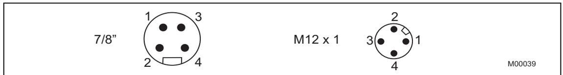
Abb. 9: Feldbus Steckverbinder
