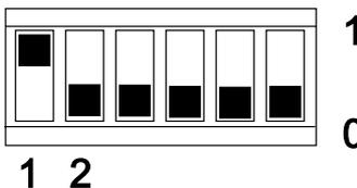
Wenn Schalter 1 eingeschaltet (Position „1“) ist, ist die Funktion MESSANFANG/MESSSPANNE anheben/absenken aktiv. Dann kann der Messbereichsendwert (URV) über die Taster – und + an der Sekundärelektronik und der Messbereichsanfangswert (LRV) über die unter dem Typschild des Messumformers untergebrachten Einstelltaster Messanfang (Z) und Messspanne (S) angehoben beziehungsweise abgesenkt werden.
