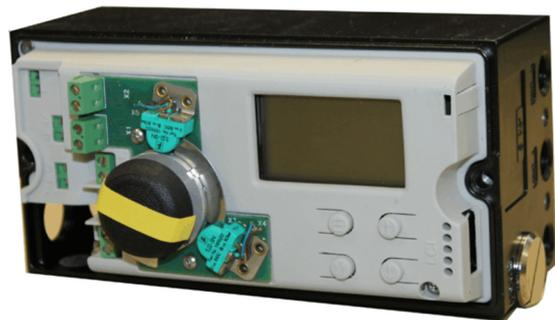
Figure 7 : TZIDC ouvert avec vue sur le pupitre de commande
