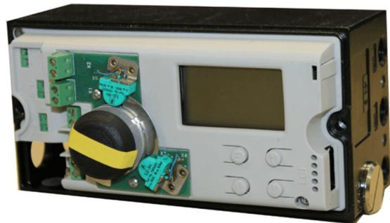
Abbildung 7: Geöffneter TZIDC mit Blick auf das Bedienpanel
