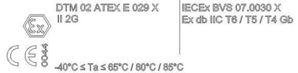
Рисунок 18: Маркировка (пример)
