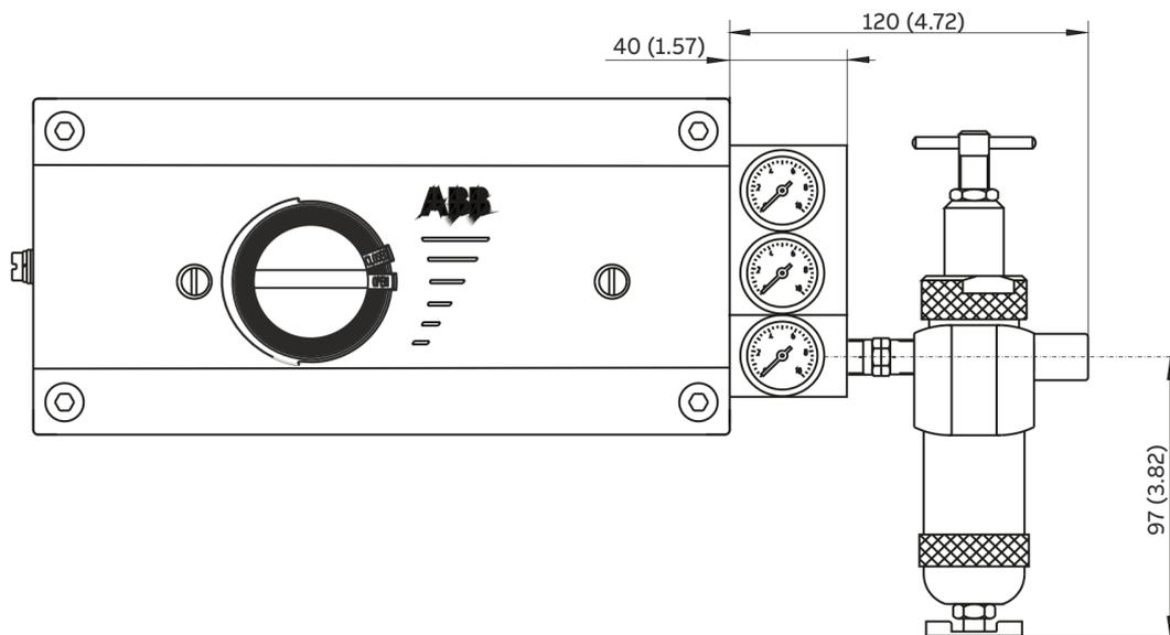
Abbildung 18: Stellungsregler TZIDC-200 mit angebaurem Manometerblock und Filterregler
