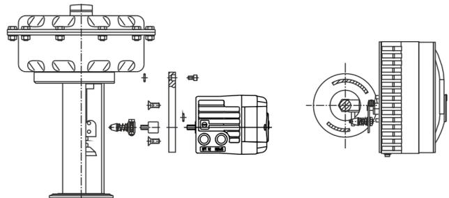
Abbildung 5: Integrierter Anbau an Regelventile mittels Adapterplatte
