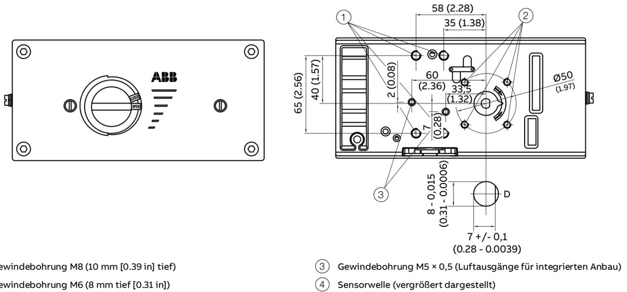
Abbildung 13: Vorder- und Rückansicht
