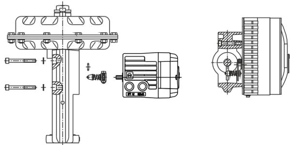
Abbildung 4: Integrierter Anbau an Regelventile
