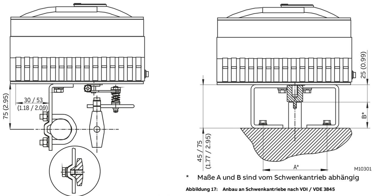
Abbildung 17: Anbau an Schwenkantriebe nach VDI / VDE 3845
