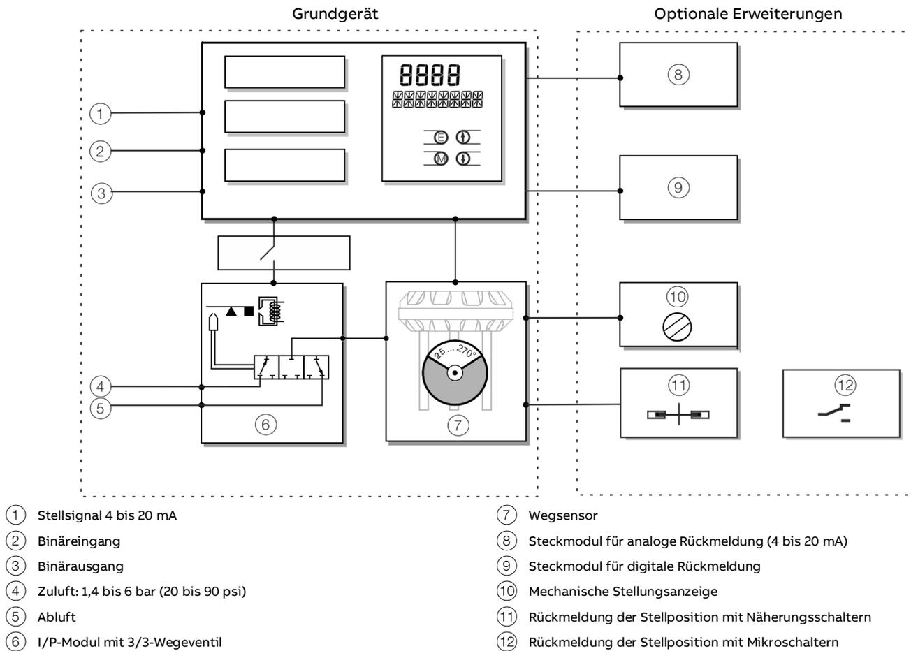
Abbildung 1: Schematische Darstellung des Stellungsreglers
