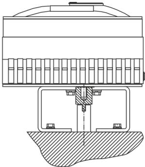
Abbildung 3: Anbau an Schwenkantriebe nach VDI / VDE 3845
