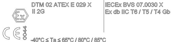
Рисунок 18: Маркировка (пример)
