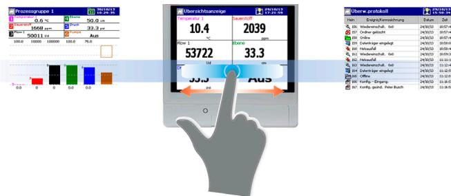
Abbildung 2 Navigation mittels Wischgesten auf dem Display
