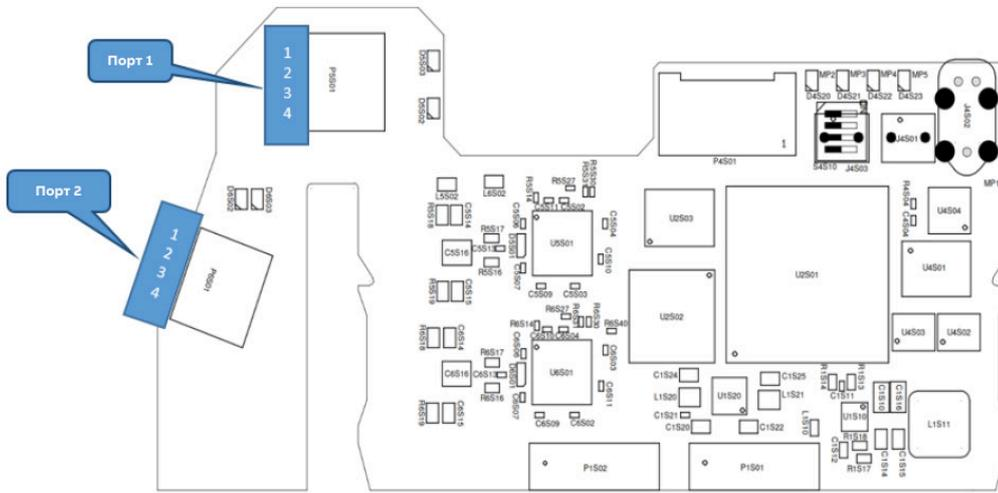
Рис. 54 Съемная сетевая карта с поддержкой интерфейса Ethernet
