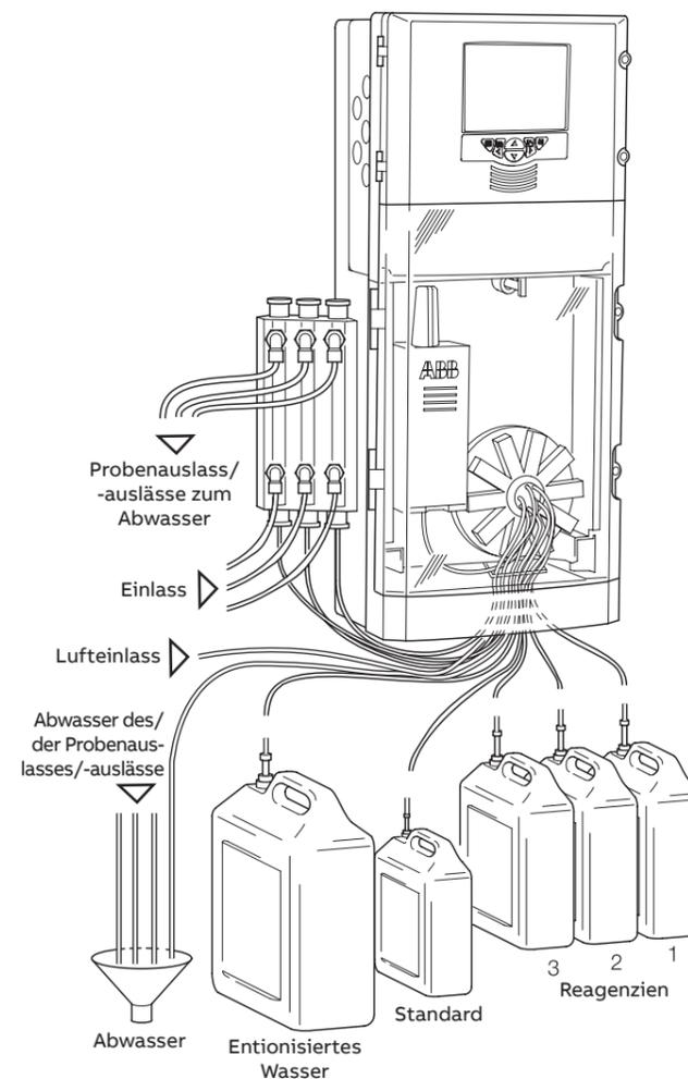
Beispiel einer Mehrfachprobenstrominstallation
