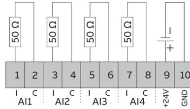
Figure 24: Analog input module
