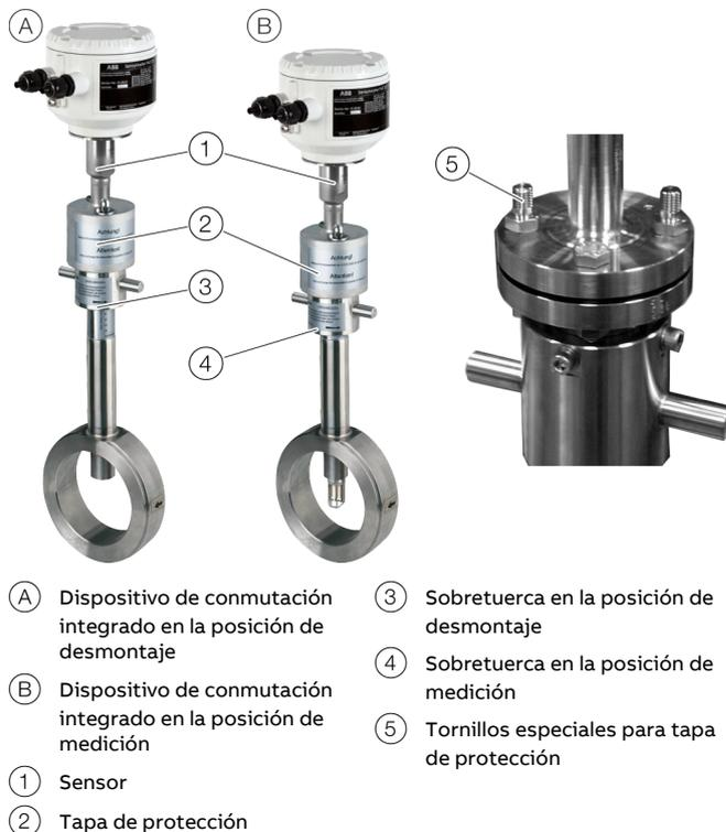
Figura 38: Dispositivo de conmutación integrado (ejemplo)
