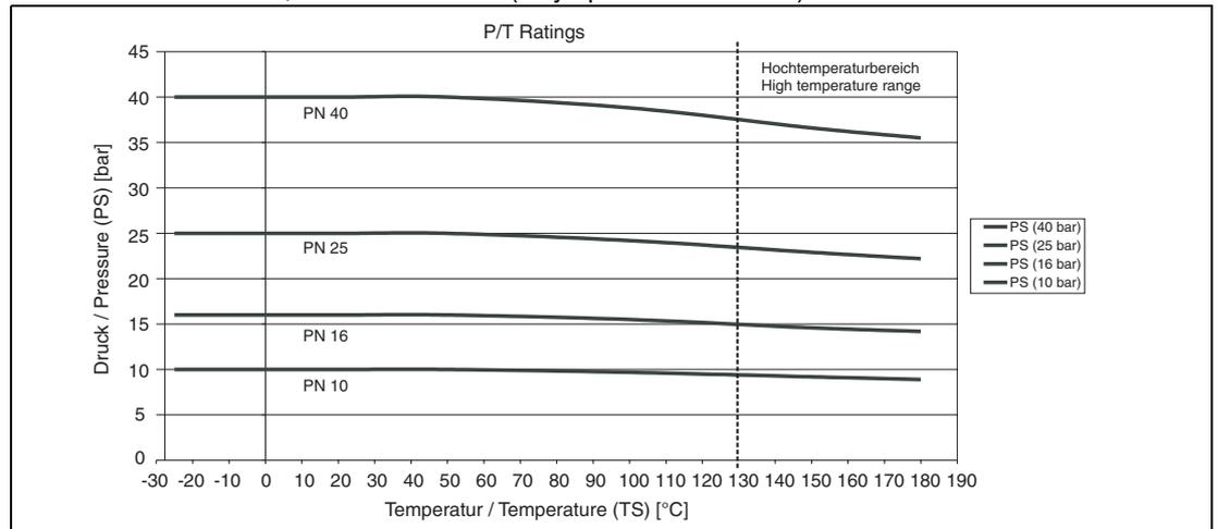
**6.1.2.2 ASME-Flansch W.-Nr. 1.4571 bis DN 600 / ASME-Flange SST 1.4571 up to DN 600**
