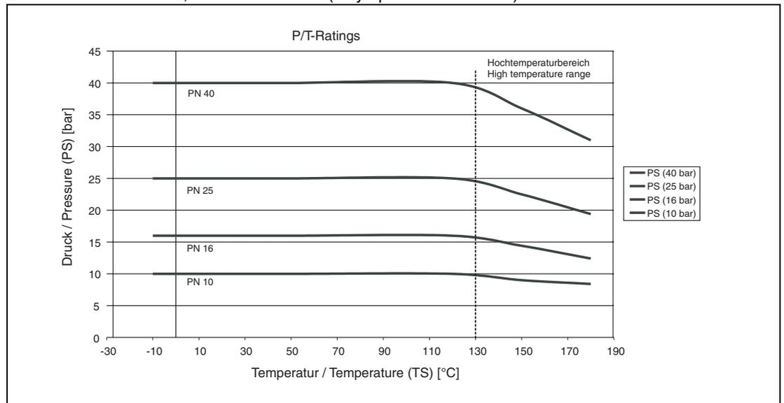
**6.1.2.4 ASME-Flansch W.-Nr. Stahl bis DN 600 / ASME Flange Steel up to DN 600**
