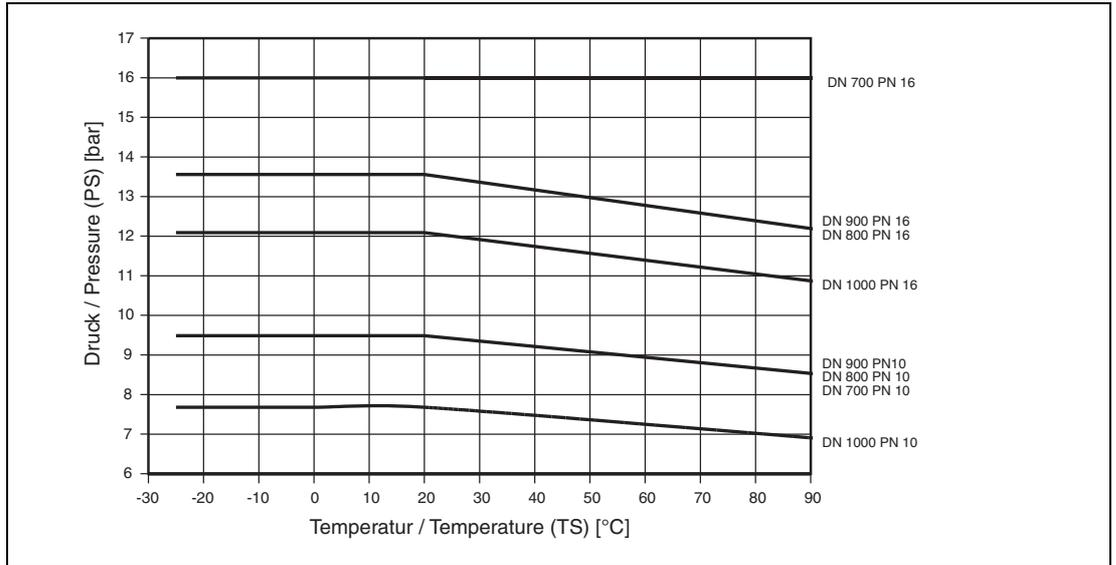
**6.1.2.7 DIN Flansch W.-Nr. Stahl ≤DN 1000 / DIN Flange Steel ≤DN 1000**
