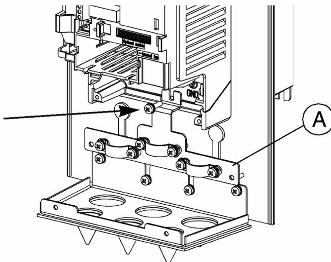
Obr. 24 Připevnění desky kabelových průchodů **silových kabelů (A)** frekvenčních měničů v provedení IP 54 / NEMA12.
