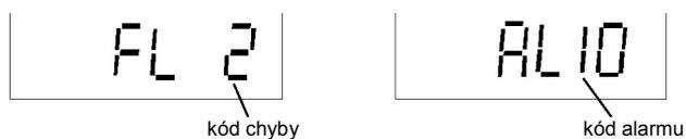
Obr. 35 Chybové a alarmové zprávy
