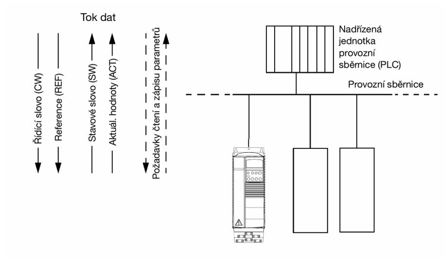
Obr. 67 Struktura systému provozní sběrnice
