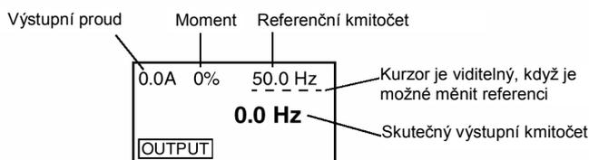
Obr.33 Výstup proměnných na displeji
