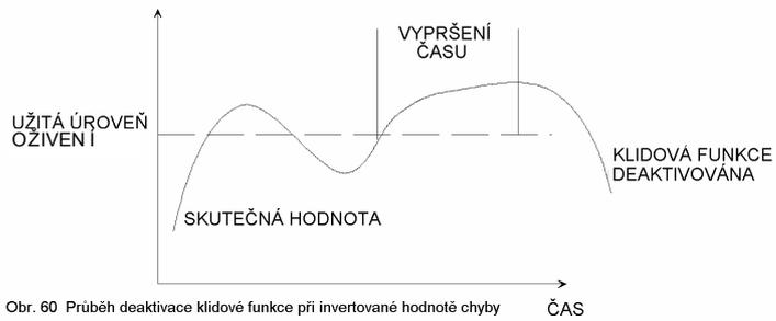
Obr. 60 Průběh deaktivace klidové funkce při invertované hodnotě chyby
