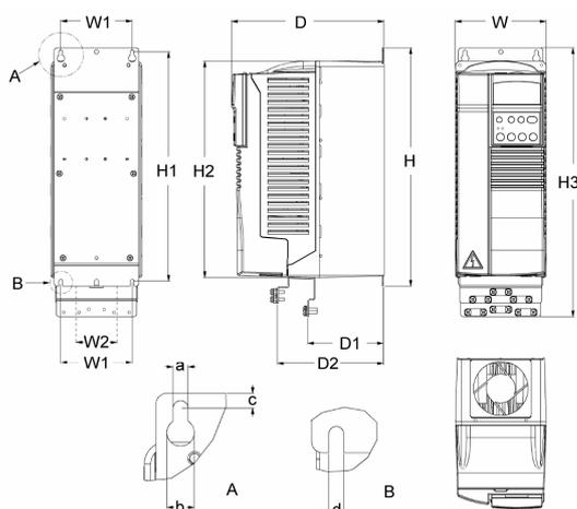
Obr. 2 Zapouzdření IP21/NEMA1
