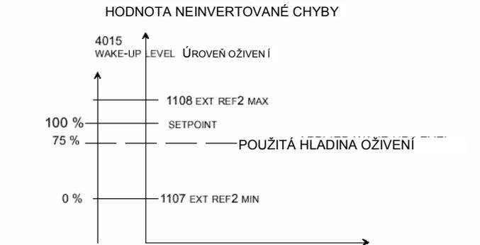
*Obr. 57 Příklad, jak použitá hladina oživení pluje s bodem nastavení, zde parametr 4015 WAKE-UP LEVEL je roven 75%, případ PID neinvertovaný regulátor.*
