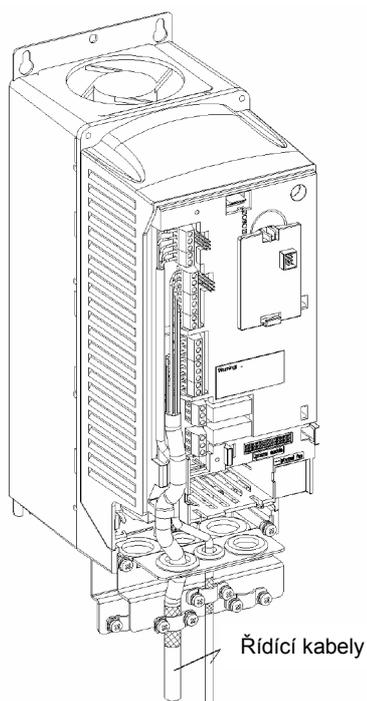
Obr. 22 Připojení řídicích kabelů (IP 21 / NEMA1).
