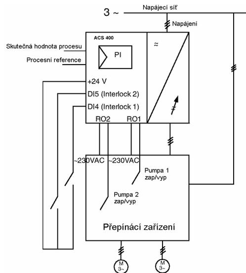
Obr. 75 V tomto příkladu je použito automatické střídání čerpadel
