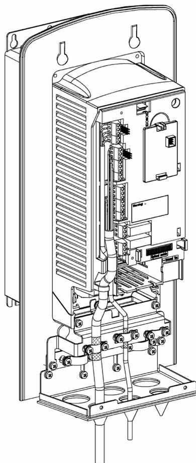
Obr. 28 Připojení řídicích kabelů (IP 54 / NEMA12).
