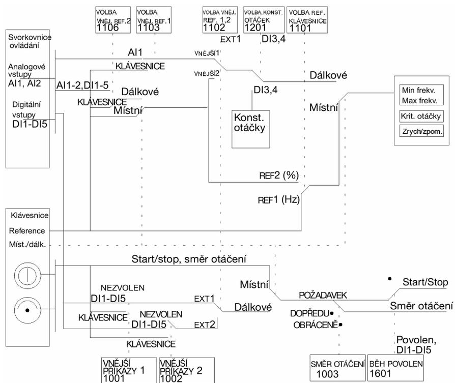
Obr. 72 Zapojení řídicích signálů aplikačních maker ABB Standard, Střídavého a Předmagnetizace
