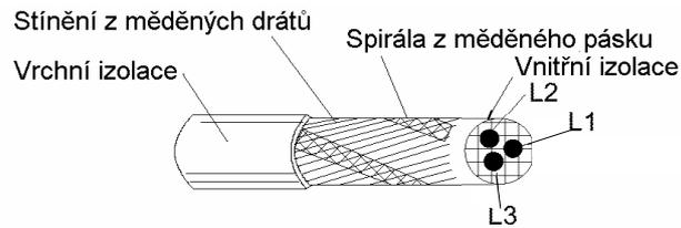
Obr. 77 Minimální požadavky na stínění motorového kabelu (např. MCMK, NK kabely)
