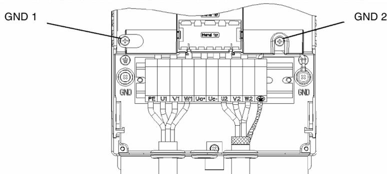
Obr. 16 Odstranění zemnicích šroubů z rámu frekvenčních měničů velikosti R3 a R4.
