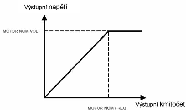
Obr. 36 Výstupní napětí jako funkce výstupního kmitočtu
