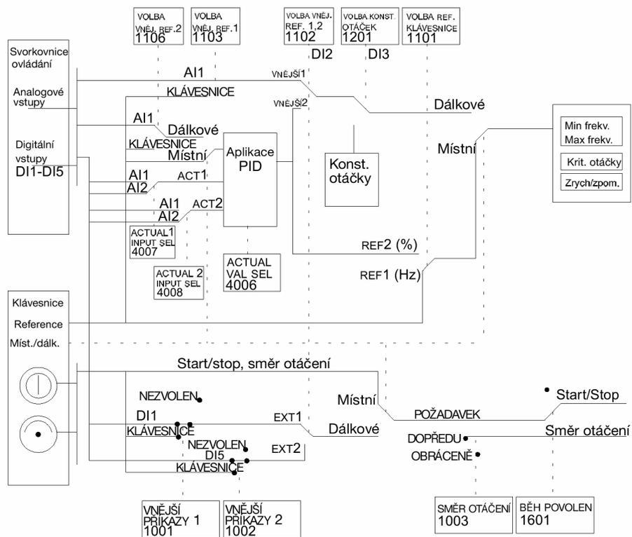
Obr. 73 Zapojení řídicích signálů makra PID regulátoru.
