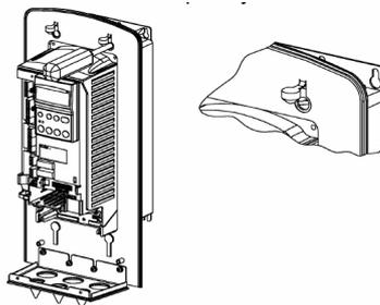
Obr. 7 Připevnění frekvenčních měničů typu IP 54/ NEMA12
