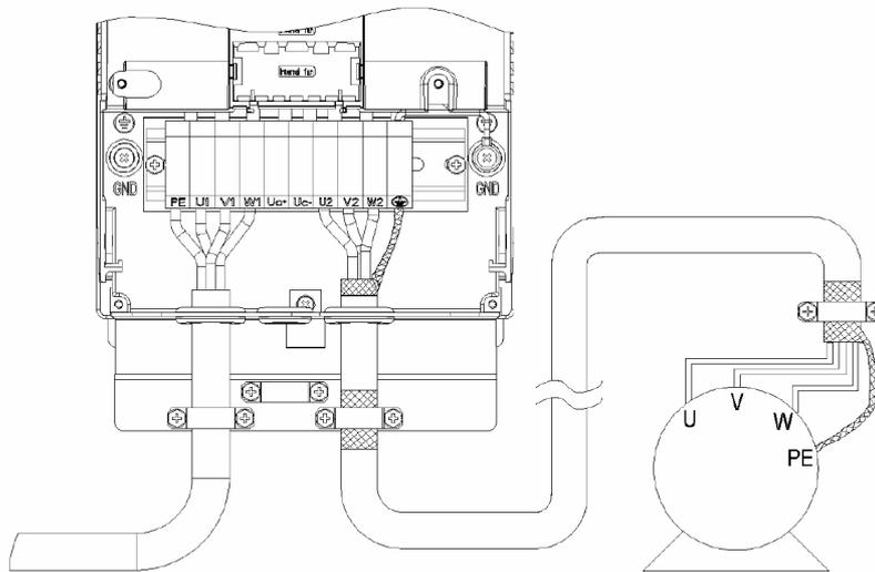
Obr. 20 Připojení kabelů pro rámy velikostí R3 a R4 (IP 21 / NEMA1).
