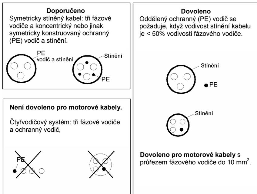
Obr. 78 Doporučení a zákazy týkající se kabelů
