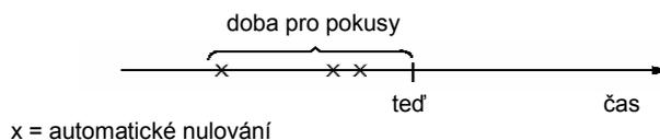
Obr. 50 Činnost při automatickém nulování. V tomto případě, nastane-li porucha v okamžiku "ted", je automaticky nulována v případě, když hodnota parametru 3101 NR OF TRIALS je větší jak nebo rovna 4.
