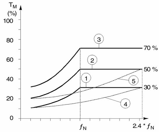
Obr. 49 Typy křivek odlehčení.  $T_M$  je jmenovitý kroutící moment motoru,  $f_N$  jmenovitý kmitočet motoru.
