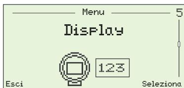
Utilizzato per impostare la *Modalità display* (righe delle informazioni visualizzate sulle *Pagine operatore*), abilitare o disabilitare *Scorrimento automatico*, impostare la data e l'ora e il formato di data e ora, selezionare una regione dell'*Ora legale* e regolare il contrasto dello schermo.
