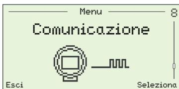
Utilizzato per configurare i parametri di comunicazione HART e la comunicazione di uscita ciclica tramite l'interfaccia IrDA sulla parte anteriore del trasmettitore.
