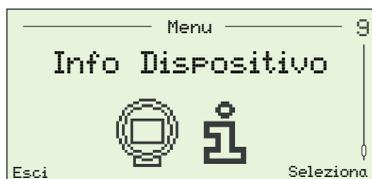
Identifica il numero di serie del trasmettitore, la data di produzione del trasmettitore, l'ultima data di taratura dell'ossigeno, il tipo di sonda, la scheda opzionale del trasmettitore (se montata), l'hardware Autotar. (se montato) e i codici della scheda principale e della versione software.
