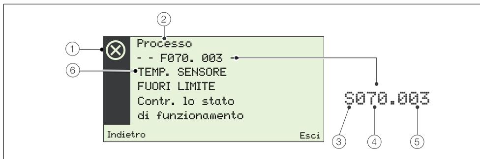
Fig. 9.1 Esempio di messaggio di diagnostica e componenti
