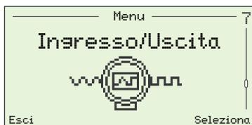
Utilizzato per assegnare i relè (1 e 2), l'ingresso/uscita digitale (1 e 2) e le uscite corrente (1 e 2).
