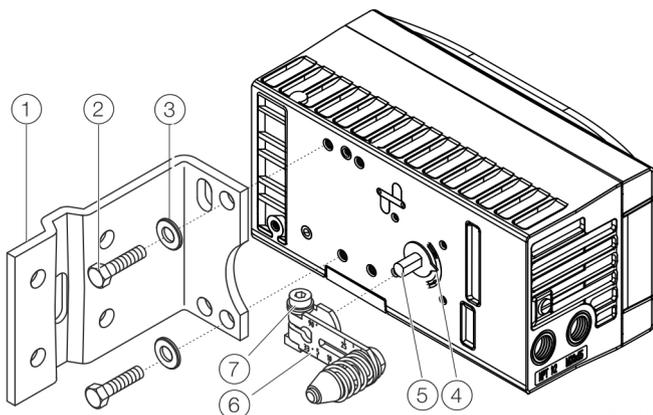
Abbildung 10: Hebel und Winkel am Stellungsregler montieren
