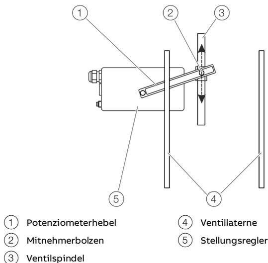
Abbildung 14: Mitnehmerbolzen am Ventil
