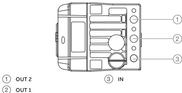
Abbildung 21: Pneumatische Anschlüsse
