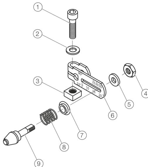
Abbildung 9: Hebel zusammenbauen (falls nicht vormontiert)
