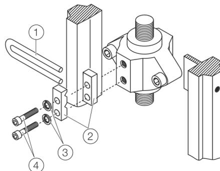
Abbildung 8: Bügel an den Antrieb anbauen
