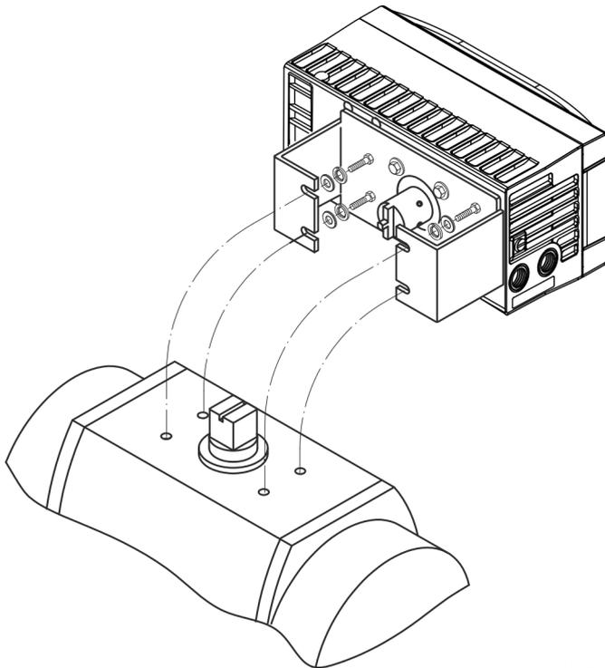
Abbildung 18: Stellungsregler am Antrieb anschrauben
