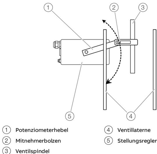
Abbildung 13: Mitnehmerbolzen am Hebel
