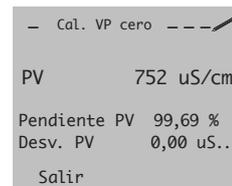
Después de una calibración errónea, se muestra el motivo del fallo.
