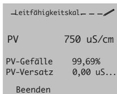
Nach einer misslungenen Kalibrierung wird der Grund für den Fehler angezeigt.
