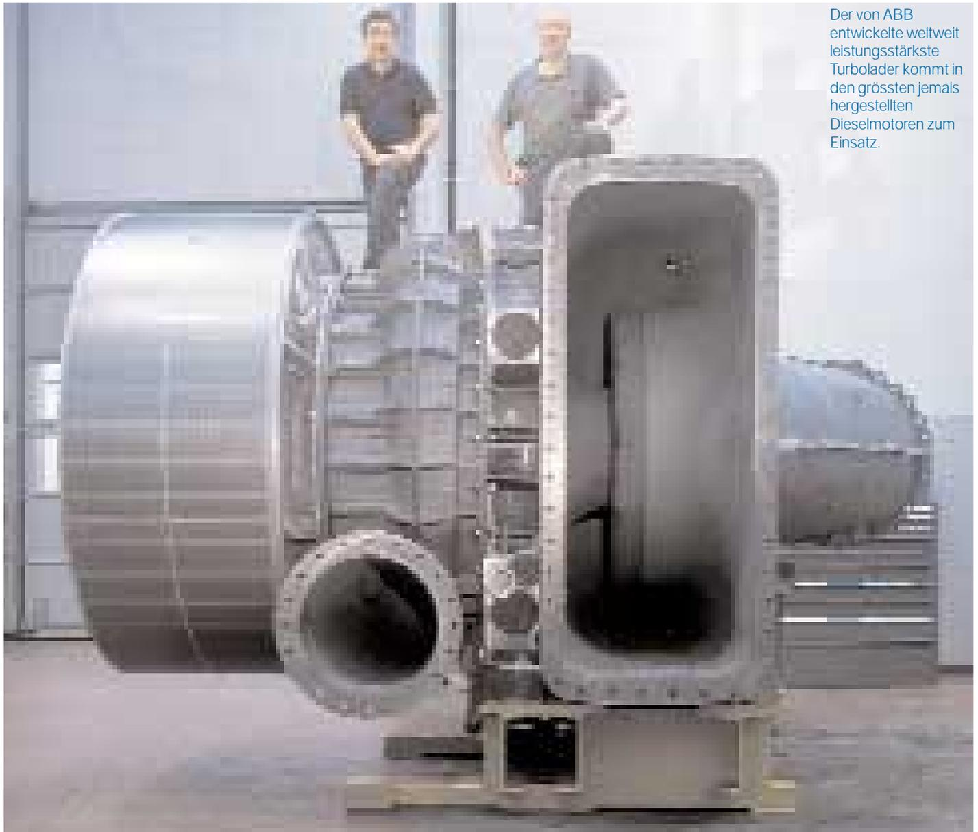
Der von ABB entwickelte weltweit leistungsstärkste Turbolader kommt in den grössten jemals hergestellten Dieselmotoren zum Einsatz.
