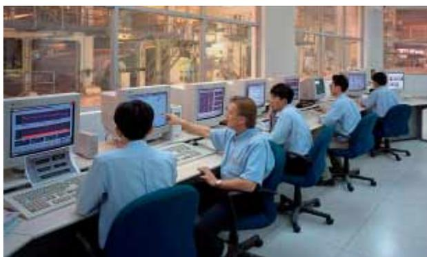
Produktionsmanagement-Systeme von ABB integrieren Daten von Tausenden von fabrikweiten Messpunkten, um Qualität, Ausstoss und Sicherheit zu erhöhen.
