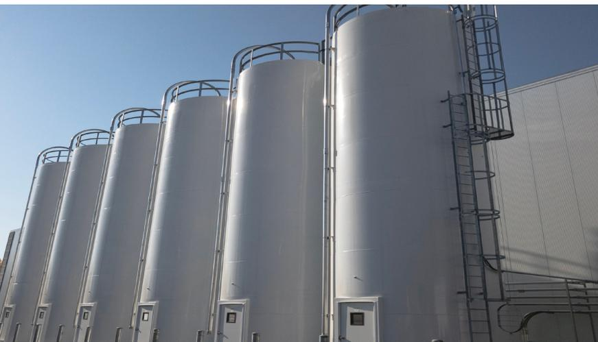
— Silos de almacenamiento para granulado de plástico
