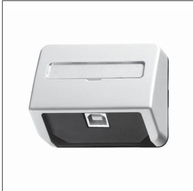
Das Anwendungsmodul USB-Schnittstelle dient zur Ankopplung eines PC mithilfe einer USB-Datenleitung an den EIB. Die USB-Schnittstelle wird auf einen Busankoppler UP aufgesetzt. Sie kann innerhalb des Systems an einer beliebigen Stelle integriert werden.
