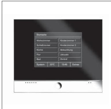
Bei dem Raumpanel handelt es sich um ein hochwertiges EIB-Touch-Display. Das Raumpanel bietet ca. 30 Bedienfunktionen mit einem monochromen Display. Eingesetzt wird es als raumübergreifende Steuer-, Melde und Kontrolleinheit für die gesamte EIB-Anlage.
