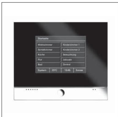
Bei dem Controlpanel handelt es sich um ein hochwertiges EIB-Touch-Display. Das Controlpanel bietet ca. 100 Bedienfunktionen mit einem monochromen Display. Eingesetzt wird es als raumübergreifende Steuer-, Melde und Kontrolleinheit für die gesamte EIB-Anlage.
