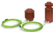
Les capteurs de tension à moyenne tension d'ABB sont fondés sur la technologie de diviseurs résistifs ou capacitifs. Ces capteurs sont non saturables et sont linéaires sur toute la portée de mesure. Le signal de sortie est une tension qui est proportionnelle à la tension primaire. Ces capteurs de tension conviennent à la fois pour la mesure et la protection. Les valeurs nominales sont disponibles jusqu'à 24 kV, et la classe de précision va jusqu'à 0,5/3P.
