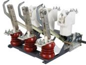
L'interrupteur-sectionneur VersaRupter utilise un système de pompe et de buse pour supprimer efficacement l'arc d'interruptions à pleine charge dont la tension va jusqu'à 38 kV et le courant jusqu'à 1 200 A.
