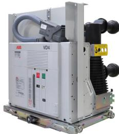
Les disjoncteurs VD4 et VM1 à moyenne tension utilisent des interrupteurs à vide encastrés dans des pôles. Cette méthode de construction rend les pôles particulièrement solides et protège l'interrupteur des chocs, de la poussière et de la condensation. L'entraînement magnétique du disjoncteur VM1 active les contacts amovibles des interrupteurs et intègre toutes les fonctions d'un entraînement conventionnel.
