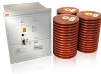
Le sectionneur de mise à la terre ultra rapide UFES est une combinaison sécuritaire et efficace de relais de détection d'arc spécifiques et d'un dispositif d'extinction d'arc composé de ce que l'on appelle les éléments de commutations primaires. En cas de défaillance d'arc interne, le relais de détection d'arc déclenche les éléments de commutations primaires UFES, ce qui entame une mise à la terre triphasée pour couper immédiatement la tension d'arc.
