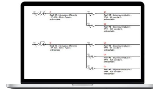
Generación automática del esquema unifilar
