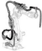
外置式DressPack配有將電纜推離手腕的伸縮臂。需少量個別調整。
