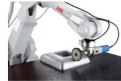
傳統機器人解決方案都是以預先編定的路徑與速度實施運行控制，而ABB集成功力控機器人能針對環境變化隨時作出回應，並根據力感測器的回饋信號調整其程式控制路徑或速度。以前只能依靠熟練操作人員憑藉高超技藝或是採用昂貴的高剛性自動化設備進行作業，如今可以通過ABB集成功力控機器人實現生產自動化。
