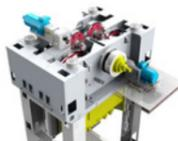
DDC在沖壓操作時加快壓機的開閉頻率，以飛輪儲存能量，從而在有限峰值功率條件下實現新增與既有的壓機對伺服技術的充分利用。該技術提供一個“伺服包”（齒輪電機和傳動），同自動化設備一起集成於同一主控設備中。DDC生產線速度可比普通生產線快30%。
