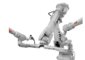
MultiMove系統採用通用控制器控制多達四台機器人，每台機器人均裝備有單獨的驅動模組。MultiMove系統分兩種不同的模式：獨立式和協作式。
