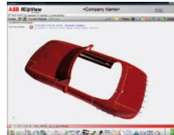
通過RobView 5 可管理包含單台或多台機器人的噴塗系統，監視整個噴塗流程，以及操作、監控噴塗機器人工作站。所有IRC5P噴塗機器人均免費配有RobView 5 基本版\*。該版本屬於經濟型圖形化使用者介面，適合配套低成本系統。對於較大型、更高級的系統，可選購外掛程式進行擴展升級。
