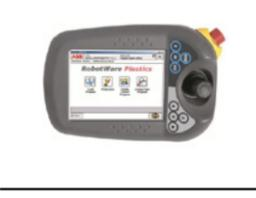
RobotWare Plastics Mold 是專為塑料行業設計的用戶友好界面，安裝了六軸機器人和這種獨特軟體的射出成型機行業用戶已經看到了好處。現在，您可以期待更高的安裝、設置和實際生產效率。ABB FlexPendant 的彩色屏幕、邏輯簡單的視覺語言和圖形用戶界面編程很容易，操作簡單，信息訪問也很容易！
