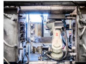
透過傳感器，根據外部設備 (例如注塑機、壓鑄機或沖壓機) 調整機器人速度。進一步提高機器人生產的產量，從而減少 cycle time。
