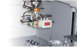
RobotWare Force Control（力控）實現了機器人運用“觸感”執行作業，可應用於組裝、夾取、產品測試等環節。該選購軟體以力控概念為基礎，這種控制策略能使機器人的動作不斷適應來自力感測器的回饋信號。機器人可自動搜索正確位置，並且利用智慧化的力/轉矩運動功能進行零件組裝，絕無動作卡死或損傷零件的風險。
