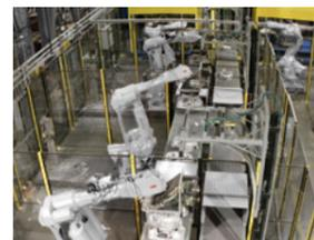
傳送帶跟蹤 (又稱線性跟蹤) 實現了機器人對傳送帶上移動工件的跟蹤功能。跟蹤傳送帶時，即使傳送帶速度有緩慢變化，相對於工件的程式控制TCP速度仍保持不變。
