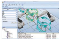
噴塗套裝軟體 (RobotStudio Painting PowerPac) 將噴塗程式設計知識及工藝工具融入RobotStudio，可加快噴塗機器人及噴塗設備的程式設計與類比進度，增強程式設計直觀性、噴塗行程的創建與編輯易用性。程式可自動添加噴塗事件指令，自動選定事件觸發軸。機器人加速、減速位置也可自動計算。噴塗工藝性能參數可離線預測。
