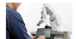
Robot Control Mate 插件讓用戶能夠透過電腦jog、示教和校準機器人，從而使控制移動機器人變得更加簡便。這也是ABB離線編程軟件首次可用於即時性操控機器人直接移動。適用機型：IRB 910INV、IRB 1300、IRB 1100 及IRB 14050。
