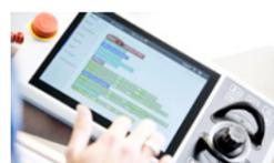
Wizard Easy Programming 是一種圖形化的編程方法，使用戶能夠為單臂 YuMi、IRB 1100、CRB 1100 和 CRB 15000 等機型創建程序。編程軟件基於Blockly，一個可視化開源編輯器，將編程語言或代碼顯示為流程圖形塊。該軟件涵蓋了機器人的多種功能，如“移動”、“抓取”或“真空吸抓取”。因此，機器人通常執行的任務範圍很廣。由於 Wizard Easy Programming 顯著簡化了複雜的編程，包括錯誤處理，現在每個用戶都能夠快速開發複雜有效的機器人程序。
