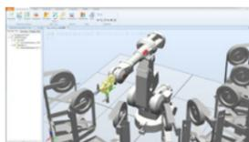
機加工套裝軟體 (Machining PowerPac) 將程式設計難度降低一半，同時又優化了機加工刀具路徑，提升產品加工量。PowerPac可引導使用者，從所導入的CAD模型的表面和邊緣創建精確的目標與路徑，還能在模擬系統中調控相關工藝參數。
