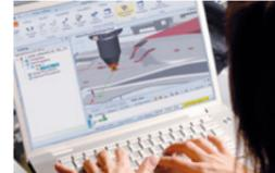
切割套裝軟體 (RobotStudio Cutting PowerPac) 是一款離線程式設計工具，操作人員可使用該工具在離線3D模擬環境中（而非在製造現場）創建、修改並驗證切割程式。切割套裝軟體可與RobotWare Cutting 無縫集成。
