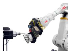
實現複雜工件表面與邊緣的簡易程式示教和自動路徑生成，為拋光、去毛刺和研磨等機加工工序大幅降低了技術障礙。相較於傳統的機器人位置控制技術，力控貫穿整個加工過程，增強工具與工件之間接觸力的感知，保證工件加工品質。ABB各個機加工專用機器人分別配套不同的力控功能組塊。
