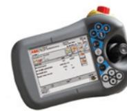
適用於Fronius、RPC、Esab、Lincoln和Miller電源套件。簡單易用的FlexPendant（示教器）圖形化使用者介面為操作員一站式提供程式設計、工作站狀態監控、關鍵品質和生產資料顯示等各項功能。FlexPendant僅設少量按鈕，介面直觀如PC機，提供多語種支援，操作員只需經過簡單培訓，即可勝任焊接作業管理。FlexPendant還集成了電源介面，操作員可全面控制電壓、電流、速度、氣流等參數。
