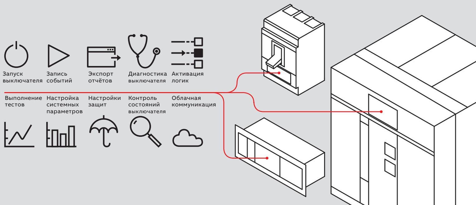
Ekip Connect - ПО ABB для программирования, настройки и эксплуатации, способное полностью раскрыть потенциал автоматических выключателей и повысить эффективность электроустановки.
