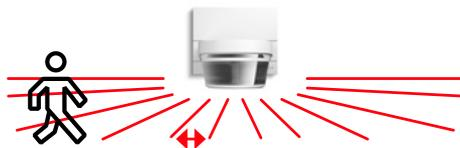
Zurzeit sind zwei ausgereifte Techniken erhältlich: Radar und Infrarot. Radarmelder erkennen Bewegungen auch durch Wände hindurch. Das kann im Zweifelsfall aber zu unnötigen Licht-Schaltungen führen.
