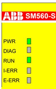
In diesem Zustand wird die Sicherheitsanwendung regulär ausgeführt, sofern das Bootprojekt geladen ist. Kein Fehler mit Schweregrad 1 oder 2 vorhanden.
