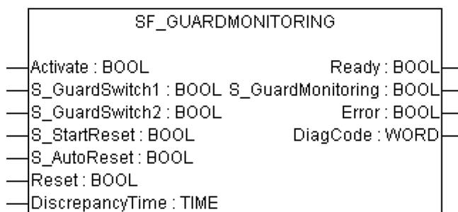
Dieser Funktionsbaustein überwacht die relevante Schutzeinrichtung. Es gibt zwei unabhängige Eingangsparameter für zwei Schaltelemente an der Schutzeinrichtung, gekoppelt mit einer Zeitdifferenz (MonitoringTime) zum Schließen der Schutzeinrichtung.
