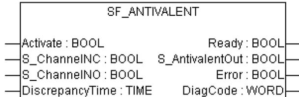
Dieser Funktionsbaustein konvertiert zwei antivalente BOOL-Eingänge (NO/NC-Paar) in einen BOOL-Ausgang, einschließlich Diskrepanzzeit-Überwachung. Dieser Funktionsbaustein sollte nicht alleine verwendet werden, da er nicht über eine Wiederanlaufsperrung verfügt. Er ist erforderlich, um den Ausgang mit anderen Sicherheits-Funktionsbausteinen zu verbinden.
