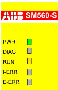
Der Zustand DEBUG RUN (nicht sicher) wird erreicht, wenn die Online-Menüpunkte aus dem „Online“-Menü aus dem sicheren Modus RUN verwendet werden (außer „Einloggen“, „Ausloggen“ und „Prüfe Bootprojekt der Steuerung“). Der Anwender kann einen Breakpoint im Sicherheitsprogramm definieren, einen „Einzelschritt“ ausführen, Variablenwerte erzwingen und schreiben und andere in AC500-S Programming Tool verfügbare Debugging-Funktionen ausführen.
