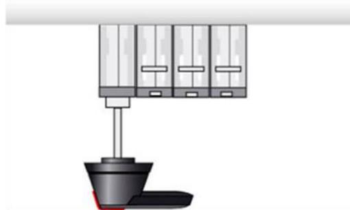
I sezionatori possono essere installati in qualsiasi direzione, orizzontalmente o verticalmente, anche nel soffitto.
