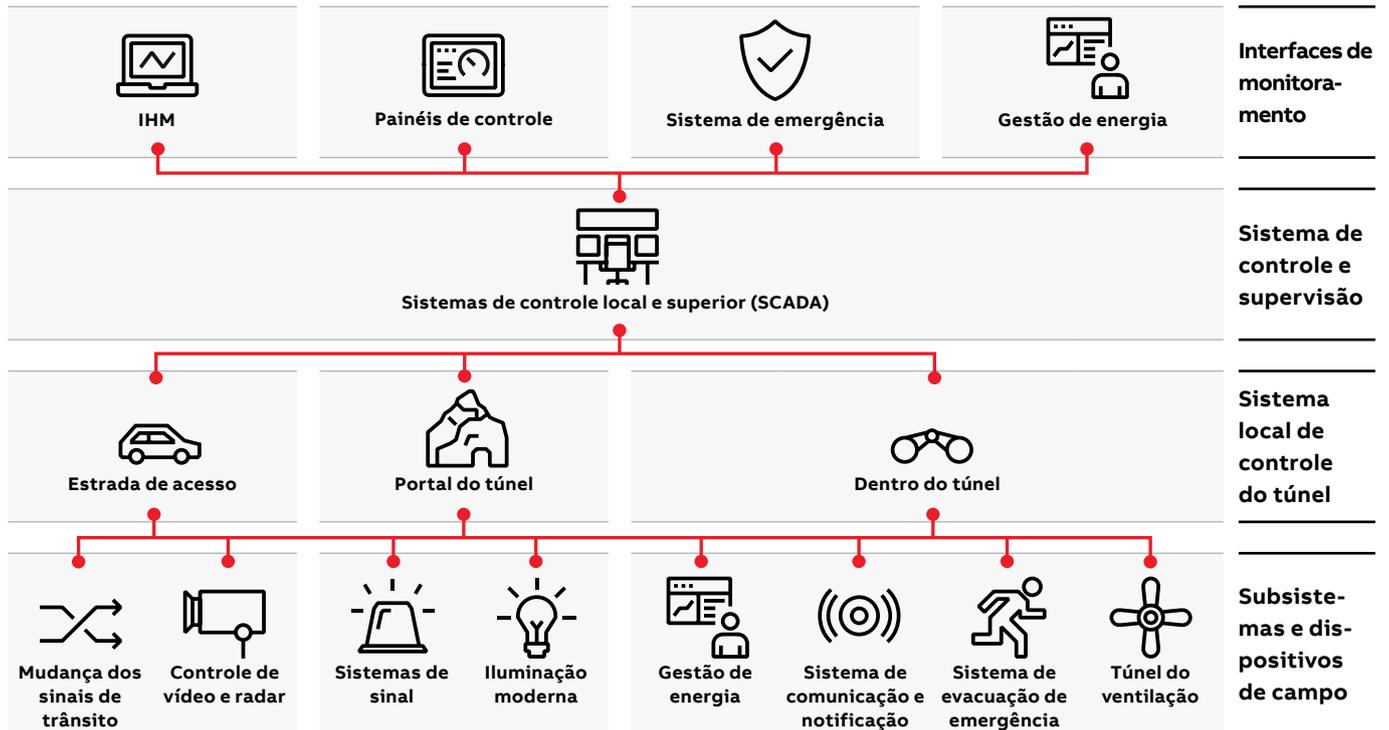
A ABB oferece um portfólio de sistemas de controle de nível superior (SCADA) que atuam sobre a arquitetura local baseada em PLC da ABB. Todos os subsistemas técnicos e dispositivos de campo do sistema de túneis podem ser controlados e monitorados a partir de um ou vários locais centrais.
