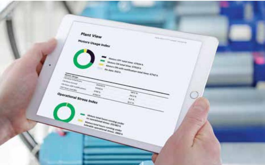
O powertrain digital utiliza o ABB Ability™ Smart Sensors para coletar dados dos motores, rolamentos montados, engrenagens e bombas para gerar relatórios com informações detalhadas que ajudam a melhorar o desempenho de aplicações acionadas por motor.
