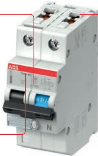
Neue, patentierte Doppelklemmen mit unverlierbaren Schrauben für ein Höchstmass an Komfort, Sicherheit und Flexibilität. Der Anschluss erfolgt in zwei Kammern (35mm<sup>2</sup> und 10mm<sup>2</sup>). Pro Kammer können zwei Leiter gleichen Querschnitts angeschlossen werden.
