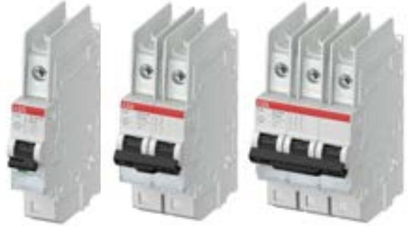
Der neue Leitungsschutzschalter SUP400 ist ein Gerät, dass für den UL Markt verwendet werden kann. Der entspricht der UL489 Norm und kann mit 277/480V betrieben werden. Es gibt 1- bis 3-polige Geräte mit der Charakteristik K. Somit kann das Gerät mit dem SMISSLINE Stecksockel-system eingesetzt werden. Neu ist auch das 250A Power Bar System nach UL508 zertifiziert. Das Gerät bietet die Möglichkeit Anwendungen für den Nordamerikanischen Markt zu realisieren.
