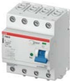
Das Einsatzgebiete der Fehlerstromschutzschalter (RCCB) Typ B sind vorwiegend in Gewerbe- und Industrie. Die RCCB Typ B eignen sich für nicht-lineare Schaltungen, die Fehlerströme mit glatte Gleichfehlerströmen und mit unterschiedlichsten (Hoch-/)Frequenzen generieren können. Diese Komponenten befinden sich in elektronischen Betriebsmitteln wie Frequenzumrichtern. Die RCCB Typ B haben einen Frequenzbereich von 0...2kHz zur Erfassung des Fehlerstroms und bieten eine hohe Anlagenverfügbarkeit.
