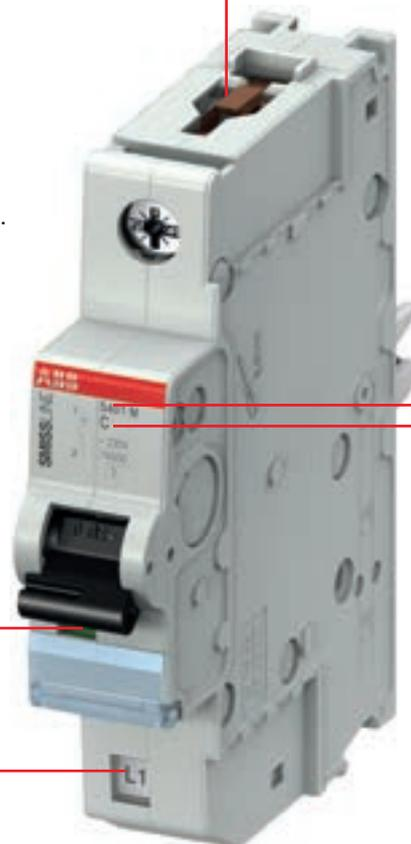
Auslösecharakteristiken B, C, D, K, UCC und UCZ. Bemessungsschaltvermögen von 6 kA bis 10 kA nach IEC/EN60898-1 (B, C, D) und 6 kA bis 25 kA nach IEC/EN60947-2 (C und K)
